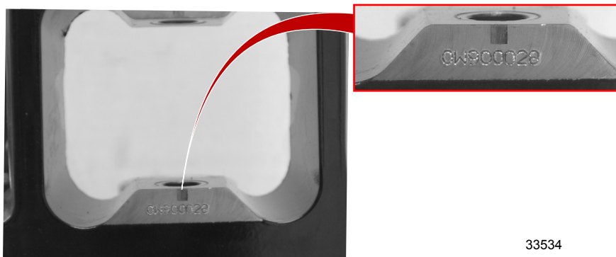
Estampage du numéro de série de la transmission en Z Bravo
